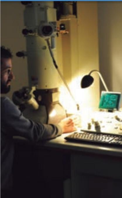
La Unidad de Microscopía Electrónica comenzó su actividad a principios de 2012. Cuenta con un microscopio de transmisión marca JEOL, Modelo JEM-1011 equipado con una cámara digital Gatan, mod. SC1000 Orius de alta resolución que proporciona excelente calidad de imágenes. Este microscopio permite el análisis de secciones ultrafinas de células y tejidos, así como la observación de preparaciones de microorganismos y complejos macromoleculares contrastados con tinción negativa.
